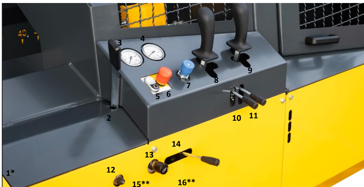
Hydraulické ovládání s přehledně uspořádanými pákami
